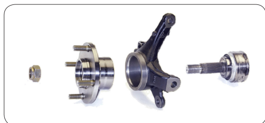
Rolamento HBU 2.1 e componentes adjacentes
