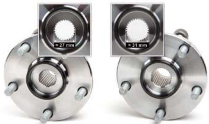
Kuva 2: Puoliakselien kiinnityshalkaisija on erilainen
