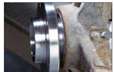
Kuva 3: Lukitusrenkaan täytyy olla olka-akselin tasolla
