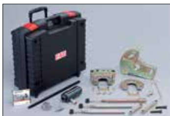
Obrázek 2: 400 6199 10 – Pro opravu je nezbytné použít speciální nářadí
