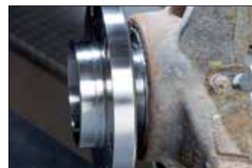
Obrázek 3: Pojistný kroužek musí být v rovině s ramenem nápravy
