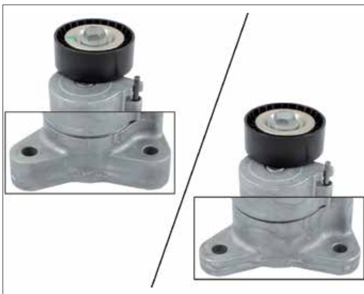
Obrázek 3: Vlevo, staré provedení s širšími upevňovacími body. Vpravo, nové provedení s užšími upevňovacími body.
