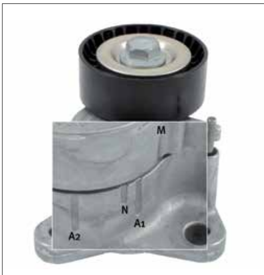
Obrázek 2: Změněné značení pro pracovní oblasti napínacího ramene
